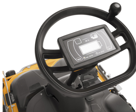
Der e-Park 220 verfügt über ein hochauflösendes 7" Display direkt im Lenkrad, das den Nutzer über aktuelle Einstellungen informiert. (Foto: Stiga)
